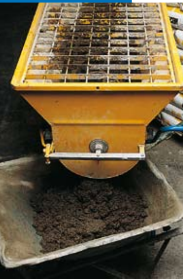
Malaxage de Mapecem avec un malaxeur horizontal
