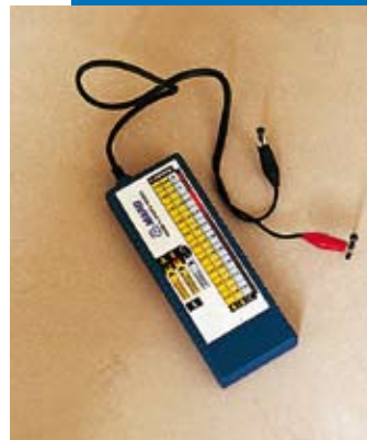
Mesure de l'humidité de la chape Mapecem avec hygromètre électronique MAPEI
