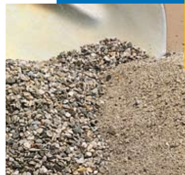
Granulats pour chape Mapecem sable de 0 à 4 mm - gravillon de 4 à 8 mm
